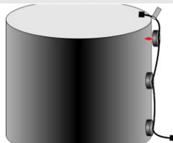
1.1 Heften Sie die magnetischen Fühler oben (mit Fähnchen), mittig und unten direkt auf den Stahltank **unter** der Dämmung
