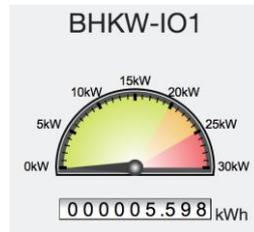
3.1 Après 2 minutes environ, les instruments indiquent la puissance actuelle [kW] et l'énergie totale [kWh]
