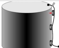
1.2 Bevestig de magnetische sensor aan de bovenkant (met vlaggetje), in het midden en onderaan direct aan de stalen tank onder de isolatie
