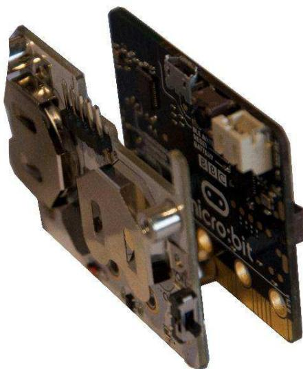
Skręcić płytki Power:bit i micro:bit ze sobą. To samo wykonać dla pinów 1, 2 i 3V.
