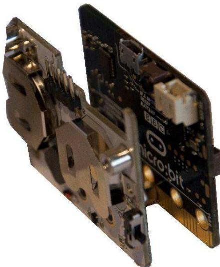
Aparafuse as placas Power:bit e micro:bit uma à outra. Proceda da mesma forma para os pinos 1, 2 e 3V.
