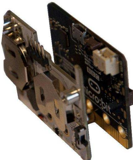
Visser le module d'alimentation et le micro:bit. Procéder de la même façon pour les broches 1, 2 en 3V.
