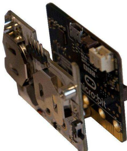
Befestigen Sie die Power:bit am micro:bit. Folgen Sie denselben Schritten für Pin 1, 2 und 3V.
