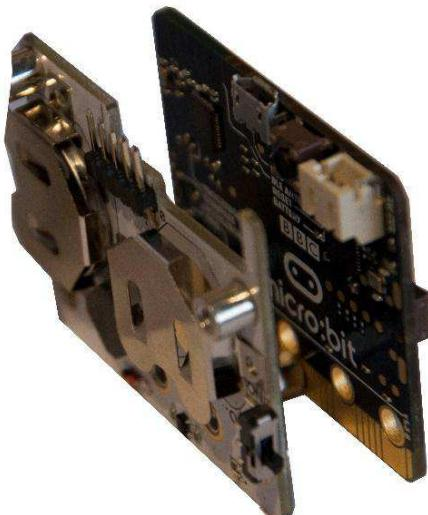
Schroef de voedingsmodule en de micro:bit aan elkaar. Doe hetzelfde voor de pinnen 1, 2 en 3V.
