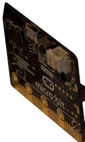
Richten Sie die Erweiterungskarte Power:bit und die Schrauben aus. Beachten Sie, dass die Rückseite der Power:bit auf der Rückseite des micro:bit gerichtet ist.
