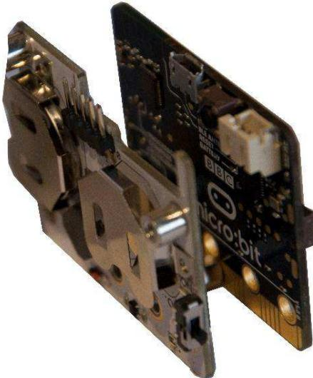
Fije la Power:bit al micro:bit atornillándola. Repita estos pasos para los pines 1, 2 y 3V.
