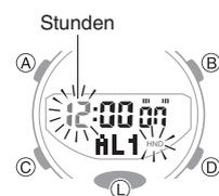
3. Verwenden Sie (D) und (B) zum Ändern der Stundeneinstellung.
