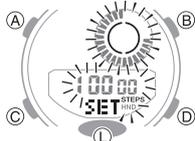
3. Verwenden Sie (D) und (B) zum Ändern der Einstellung für das tägliche Schrittziel.
