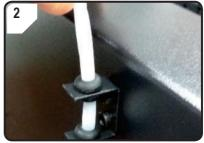
• Filament-Schlauch in die Schlauchhalterung einsetzen.
