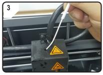
Das Filament soweit in den Schlauch einführen, bis ca. 5 cm am Extruder-Ende zu sehen sind.
