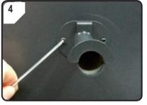
Mit zwei Schrauben und dem 2,5 mm Innensechskantschlüssel die Filament-Spulenhalterung hinten am 3D Drucker montieren. "Nase" am Ende der Halterung zeigt nach oben.
