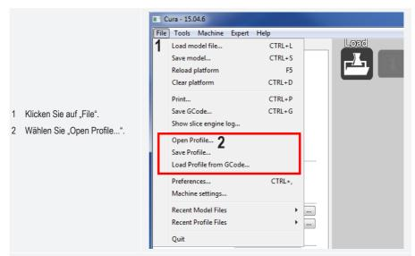
3 Wählen Sie im Auswahlfenster für das verwendete Filament eine Filament-Konfigurationsdatei aus und bestätigen Sie Ihre Auswahl .
