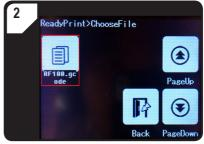
Im Ordner < 3D Models > ein druckfertiges Modell auswählen, z. B. < RF100.gcode >.
