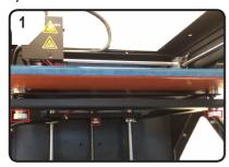
3 Nivellierschrauben unter dem Druckbett bis zum Anschlag festziehen.
