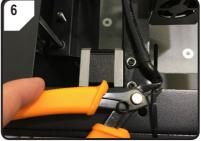
Kabelbinder auf beiden Seiten mit dem Seitenschneider durchtrennen.
