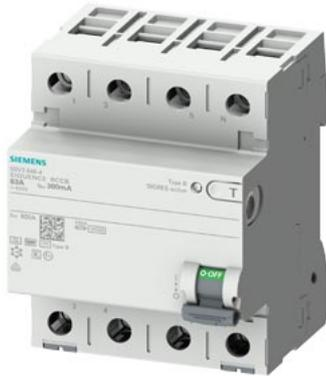
FI-Schutzschalter, 4-polig, Typ B+, kurzzeitverzögert, In: 25 A, 300 mA, Un AC: 400 V
