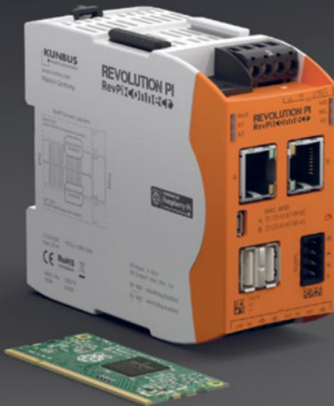
Ausgestattet mit dem Raspberry Pi Compute Module 3
