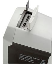
→ **Wird die Speicherkarte bei einer Speicherauslösung über die rote Auslösetaste (9) zur Bildspeicherung nicht erkannt (Kartensymbol mit einem roten X im Display), überprüfen Sie die Speicherkapazität, den korrekten Sitz bzw. die korrekte Datenformatierung (FAT32) der Speicherkarte.**
