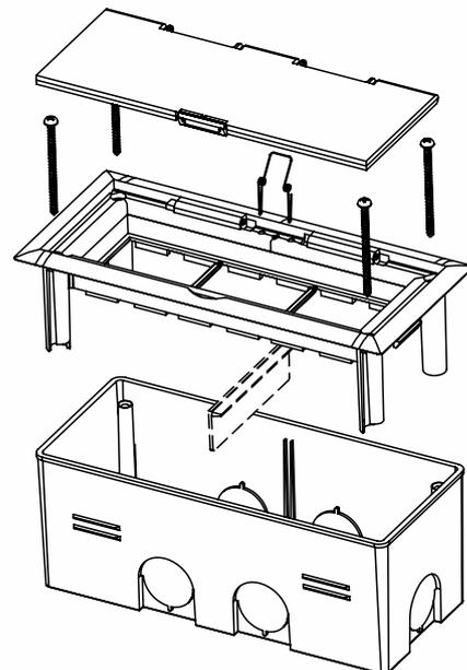
Produktbeschreibung: Geräteeinsatz für den Einbau unter Putz oder in Betonböden
