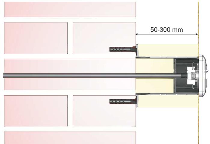
Vor der Montage ist die Halterung inkl. beigelegter Isolierung auf die benötigte Länge, entsprechend der Wärmedämmungsstärke zu kürzen.
