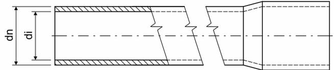
**Produktbeschreibung:** Kunststoffstangenrohr, flammwidrig, mit angeformter Muffe
