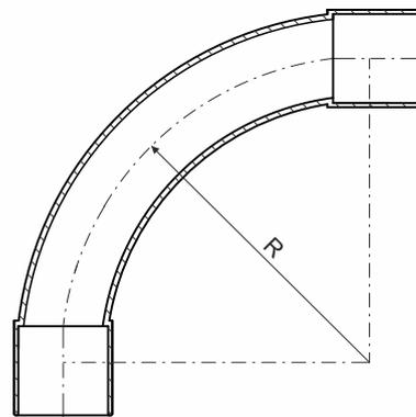
Produktbeschreibung: Bogen mit beidseitig angeformten Muffen, geeignet für Trassenbiegung um 90°
