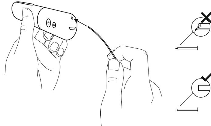
5. Jetzt können Sie ein Strang PCL Material einführen. Geben Sie Acht, dass das Ende des Stranges gerade und ohne Deformation ist. Nach dem Einführen des Stranges in den 3Dsimo Basic, drücken Sie die vordere Taste und schieben Sie leicht den Strang nach vorne.
