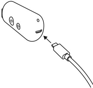
1. Nach dem Auspacken des 3Dsimo Basic empfehlen wir die Batterie aufzuladen. Nehmen Sie das beige packte USB Kabel und stecken Sie das eine Ende in den PC oder in das Mobiltelefon-Aufladegerät und das andere Ende in den hinteren Teil der Batterie.
