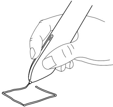
6. Das Material wird jetzt in die Spitze befördert, bis es nach 8-12 sek. aus der Spitze herausläuft.
