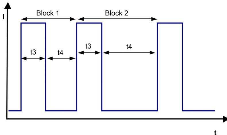
Block1: spezieller Blockierschutz 5 Zyklen t<sub>3</sub> / t<sub>4</sub> = 0,6 s / 0,5 s Block2: Blockierschutz t<sub>3</sub> / t<sub>4</sub> = 0,6 s / 10 s
