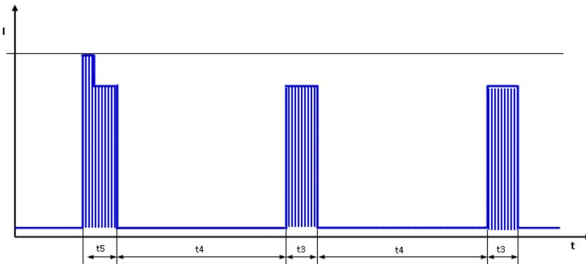
Erster Puls t<sub>5</sub> typisch 0,7s (0,5 .. 1,0s) gefolgt von t<sub>4</sub>. Danach zyklisch t<sub>3</sub>/t<sub>4</sub>.
