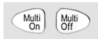
Mit der System Menu Funktion "Multi-On/Multi-Off Setup" kann die Funktion dieser Tasten den Anforderungen des Anwenders angepasst werden. So kann z. B. eine Verzögerung zwischen dem Schalten der Ausgänge eingerichtet werden, um eine On oder Off Sequenz zu bilden, oder es kann ein einzelner Ausgang von der Multi-On / Multi-Off Funktion ausgeschlossen werden.
