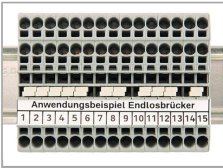
Mit dem Endlosbrücke der Serie 2002 können in nur einer Brückerspur endlos viele Klemmen mit einander verbunden werden. Die zweite Brückerspur bleibt frei.
