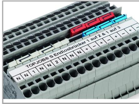
Mit dem Querbrücke für Endlosbrückung, von 1 auf 3, kann in einer Brückerspur endlos jede zweite Klemme gebrückt werden. Plus- und Minuspotentiale können so beispielweise aneinander vorbeigeführt werden.
