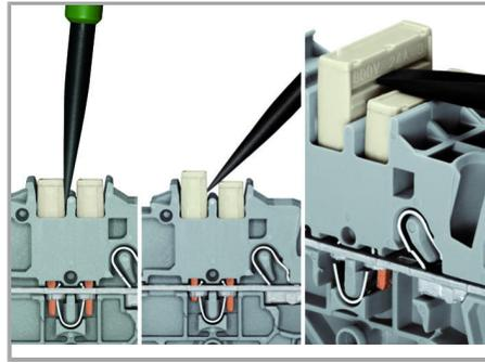
Das Kammbücker System beruht auf dem Stecker-Buchse-Prinzip. Jede Klemme ist mit einer Doppelbuchse mit Fremdfederung durch eine Cr-Ni-Stahlfeder ausgestattet. Die Brücker selbst können deshalb aus Elektrolytkupfer besonders klein gefertigt werden. Dennoch sind sie bis zum Nennstrom der Klemme belastbar. Auch PE-Klemmen sind brückbar. Individuelle Brücker entstehen durch Herausbrechen von Kontaktstiften (Serien 2000, 2001, 2002, 2004).
