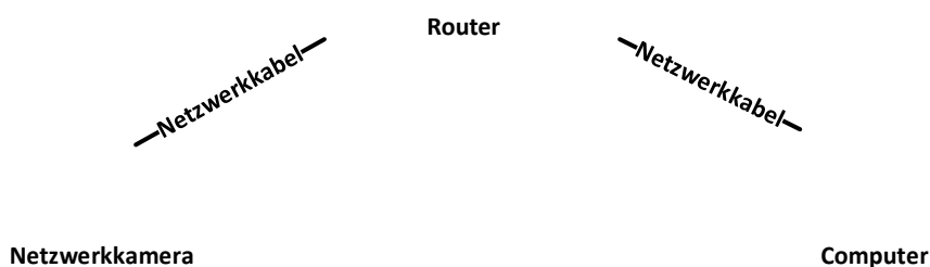
Abbildung 2-2 Verbindung über einen Router
