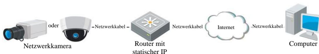
Abbildung 2–10 Auf die Kamera über Router mit statischer IP zugreifen
