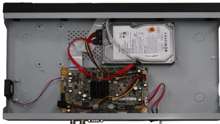
Abb. 7: Befestigung der Festplatte
