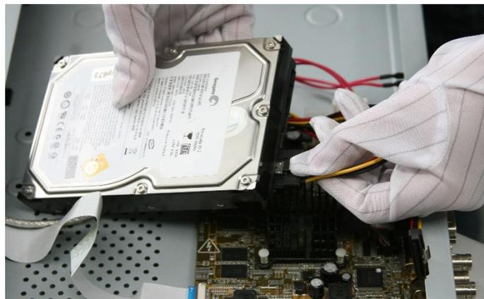
Abb. 6: Stromkabel anschließen.
