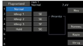
Die Auswahlfunktion für den Zustand stellt jedem Helikopter automatisch fünf Flugzustände bereit.
