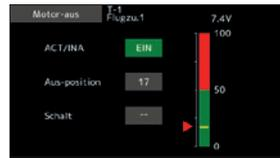
„Wenn der Gashebel in Leerlaufposition ist, Abschaltposition einstellen, bis der Motor dauerhaft AUS ist; aber die Gashebelanlenkung nicht blockiert.“
