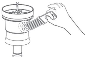
3. Filterreinigung: Filter herausnehmen, den daran haftenden Staub mit einer Bürste reinigen und waschen. Ersetzen Sie ggf. den Filter laut Angabe. Es wird empfohlen, den angegebenen Filter alle 3 Monate zu wechseln, um die Sauberkeit zu gewährleisten.
