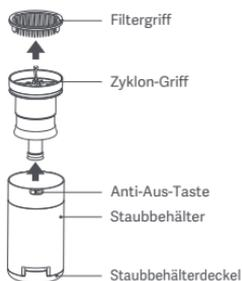
Staubbehälter einbauen: Klicken Sie auf den Anti-Aus-Knopf, setzen Sie den Staubbehälters in den Aufnahmestutzen ein und folgen Sie dem Diagramm. Drehen Sie gegen den Uhrzeigersinn, bis Sie das "Klick" hören.
