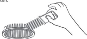
2. Reinigung von Staubbehälter und Metallgitter: Waschen Sie den Staubbehälter und das Metallgitter mit sauberem Wasser und verwenden Sie es erst nach dem Trocknen, um ein Verklumpen des Staubes bei erneutem Gebrauch zu vermeiden.
