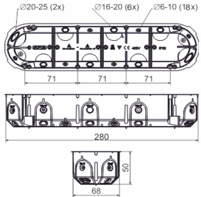
**Produktbeschreibung:** geeignet für Leitungen mit einer Spannung bis 400V und einer Stromstärke bis max. 16 A
