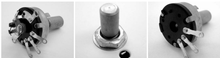
Lautstärkeregler mit Schalter und Rückkopplungsregler (Potis)
