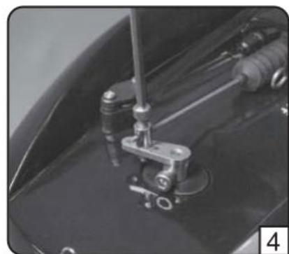
3. Schieben Sie die Ruderwelle durch die Unterseite des Hecks nach oben (Bild 3). Achten Sie dabei auf die Ausrichtung des Ruders. Verwenden Sie den 2,5mm Innensechskantschlüssel, um den Ruder Arm an der Ruderwelle zu befestigen. Vergewissern Sie sich, dass sich das Ruder frei bewegen lässt und das Spiel nach oben und unten nicht mehr als 0,5mm beträgt.
