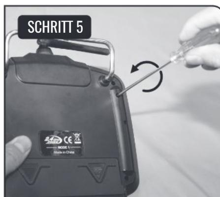
**HINWEIS:** um den MODE zurückzustellen auf MODE 2, schalten Sie zuerst den MODE Umschalter im Batteriefach auf MODE 2, bevor Sie die Schrauben in umgekehrter Richtung ändern.
