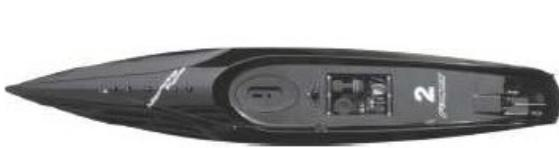
Rumpf mit Windenservo, Ruderservo, Batteriebox & Empfänger (vorinstalliert)
