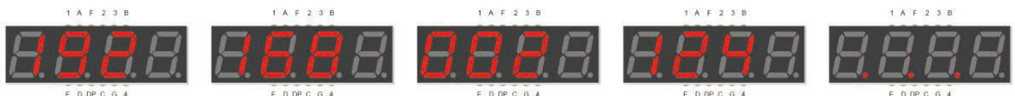
Anzeigefolge einer IP-Adresse auf der Sieben-Segment-Anzeige
