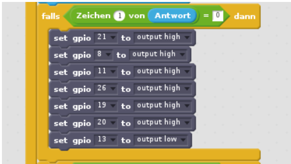
Zustand der GPIO-Pins, wenn der Benutzer eine 0 eingegeben hat.
