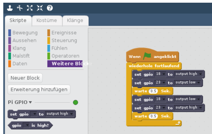
Dieses Scratch-Programm 021led02 lässt zwei LEDs abwechselnd blinken.
