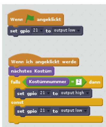
Scratch-Blöcke für das Segment A der Sieben-Segment-Anzeige
