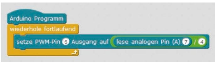
Das Programm `06mb1ock` dimmt die LED mit einem Potentiometer.
