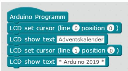
Ein einfaches Programm für einen zweizeiligen Text auf dem LCD-Modul.
