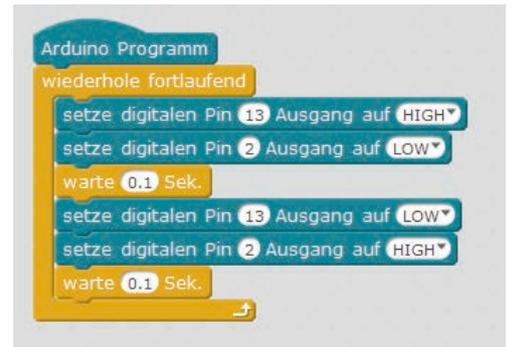
Das Programm `02mb1ock` lässt zwei LEDs abwechselnd blinken.
