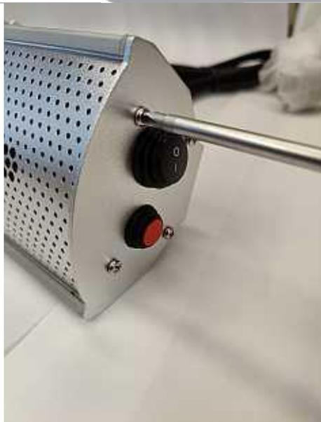
**1 - Lösen Sie die 4 Gehäuseschrauben und nehmen Sie das Elektronikgehäuse ab. Die vier Schrauben können in den Hülsen verbleiben.**
