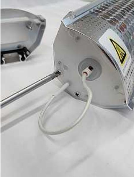
**4** - Lösen Sie die vier Schrauben für die innere Gehäuseabdeckung. Danach ziehen Sie das Röhrenkabel aus der Führungshülse. Ziehen Sie die Kabelummantelung ab und legen Sie sie beiseite.
