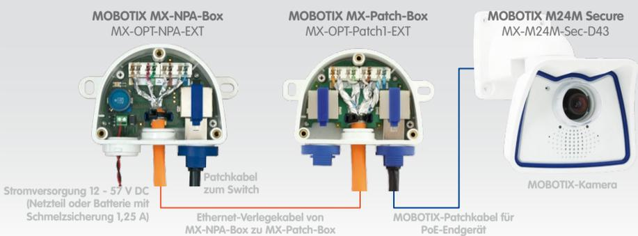
Bei dieser Variante wird anstelle des Patchkabels das Ethernet-Verlegekabel für die Übertragung der Daten und der PoE-Stromversorgung verwendet. Dies ist z. B. dann hilfreich, wenn eine IP-Kamera auf einem hohen Mast mit der als Zubehör erhältlichen MOBOTIX MX-Patch-Box montiert ist und das im Mast verlegte Ethernet-Verlegekabel erst unten in Bodennähe die Spannungseinspeisung und Datenanbindung per MX-NPA-Box erhalten soll.
