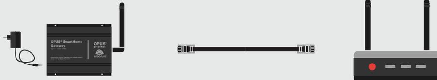
OPUS SmartHome Gateway mit Netzteil und Router verbinden
