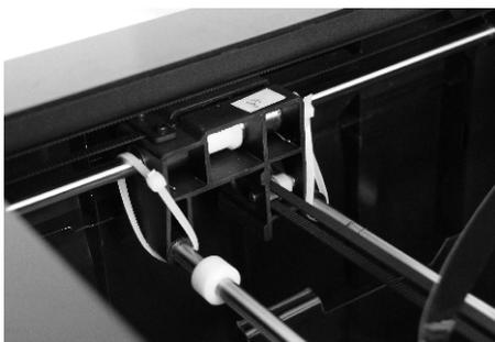
6. Durchtrennen Sie mit einer Schere die Kabelbinder, welche die Stangen halten.
