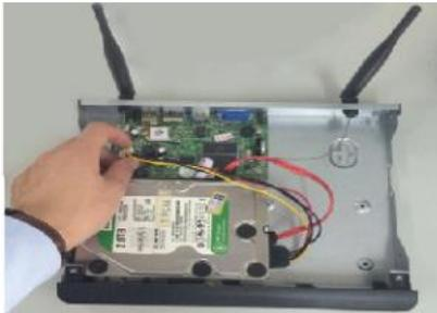
3. Befestigen Sie die Festplatte, indem Sie von unten die beigelegten Schrauben mit der Festplatte verbinden (siehe Bild).
