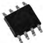
Bild 16: Beim SMD-IC ist PIN 1 durch einen Punkt an der Gehäuseoberseite gekennzeichnet.
