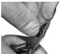
Bild 28: Der Draht wird mit einer Elektronikerrundzange zurechtgebogen.
