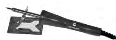
Bild 17: 15-W-FeinlötKolben von Conrad Electronic (Best.-Nr.: 588539); damit gelingt das Elektroniklöten am besten.
