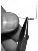
Bild 29: Bei elektrischen Bauteilen sollten die Drähte nicht direkt am Gehäuseende gebogen werden.
