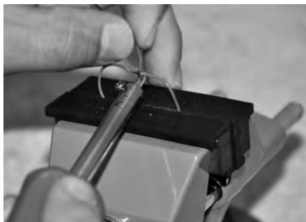
Bild 27: Da die Isolierung schnell schmilzt, muss das Zusammenlöten der Drähte schnell geschehen.
