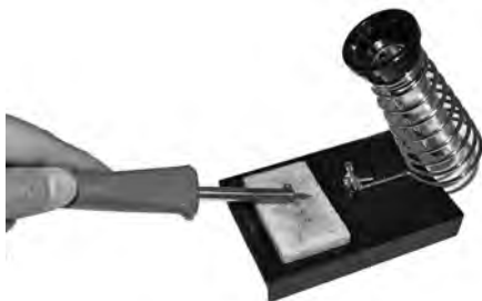
Bild 24: Deshalb sind Verunreinigungen regelmäßig am feuchten Schwamm abzustreifen.
