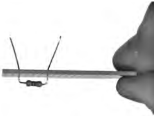
Bild 33: Damit von unten durchgesteckte Bauteile während des Lötens nicht herausfallen, sind ihre Anschlussdrähte etwas zur Seite zu biegen.
