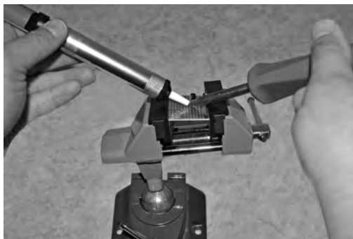
Bild 65: Das Auslöten funktioniert nur mithilfe der Entlötsaugpumpe.
