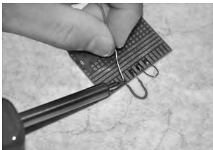
Bild 30: Anlöten von Drahtbrücken am seitlichen Streifenraster
