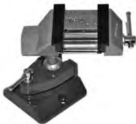
Bild 19: Im Feinmechanikerschraubstock lassen sich Platinen gut einspannen und komfortabel löten.
