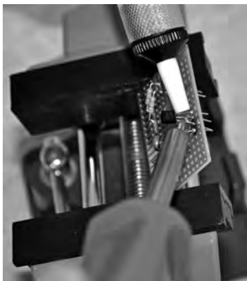
Bild 57: Lötklumpen lassen sich durch Erhitzen und Absaugen mit der Entlötpumpe entfernen.
