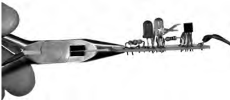
Bild 62: Die abgezwickten Anschlüsse sollten 0,5-1 mm über die Platine hinausragen.
