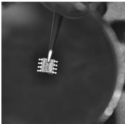
Bild 48: SMD-IC unter der Lupe – hier ist Pin 1 mit einem Kreis markiert.
