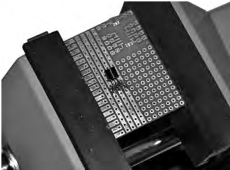
Bild 66: Mit der Entlötpumpe ist in mehreren Durchgängen das Lot von allen drei Lötunkten vollständig abzusaugen.
