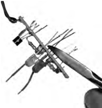
Bild 61: Überschüssige Längen der Anschlussdrähte sind nach fertiggestellter und kontrollierter Schaltung mit einer Elektronikerflachzange abzuwickeln.
