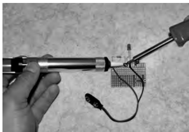
Bild 42: Große Lotmengen, wie hier die Lotbrücke zwischen Widerstand und LED, lassen sich nur mit einer Entlötsaugpumpe beseitigen.
