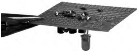
Bild 63: Anschlussdrähte sind knapp über den Lötkegeln abzuzwickeln.
