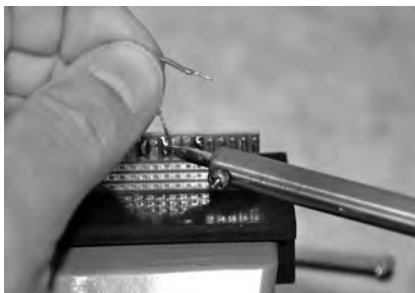
Bild 35: Während eine Lötfläche erhitzt wird, zieht man leicht mit den Fingern am Draht, bis er sich löst.
