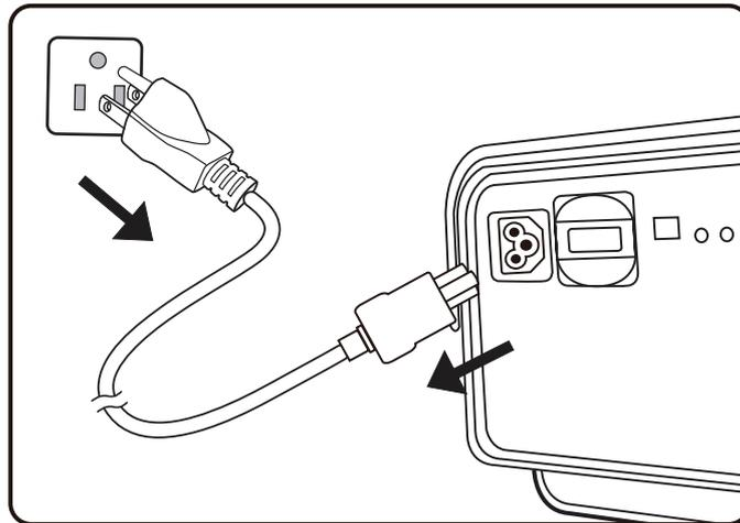
**Hinweis:** Integrieren Sie bei Installation des Projektors eine leicht zugängliche Trennvorrichtung in der Festverkabelung oder schließen Sie das Netzkabel an eine leicht zugängliche Steckdose in der Nähe des Gerätes an. Falls während des Projektorbetriebs eine Störung auftritt, unterbrechen Sie die Stromversorgung mit Hilfe der Trennvorrichtung oder durch Ziehen des Netzsteckers.
