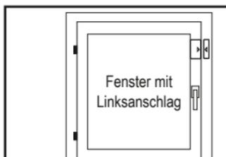
**4.2.7** Bei geöffnetem Fenster muss der Abstand zwischen Sender und Magnet mindestens 20 mm betragen. Dadurch wird ein sicheres Ein- und Ausschalten des Senders gewährleistet.
