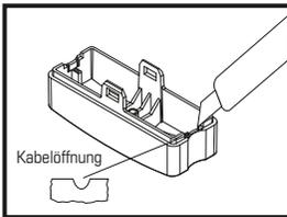
6. Breiten Sie die Öffnung am Gehäusedeckel mit dem Messer vor. Bitte beachten Sie, auf welcher Seite die Öffnung der Oberschale eingeschnitten wird. Dies hängt von der Position des Reed-Kontaktschalters am Fenster ab. Die Kabelöffnung nur so groß schneiden wie nötig, damit das Kabel durch den Gehäusedeckel fixiert wird.
