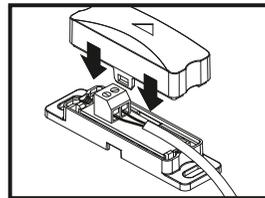
7. Setzen Sie den Gehäusedeckel auf das Bodengehäuse, bis die Laschen einrasten. Pfeil links oder rechts hängt von der Montageposition am Fenster ab.
