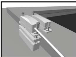
7. Befestigen Sie Magnet und Schaltkontakt mit den Schrauben an Fenster oder Türe. Die Distanzplatten dienen zum Höhenausgleich für den Magnetschalter.
