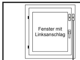
1. Überprüfen Sie genau, wie Sie den Reed-Kontaktschalter am Fenster positionieren wollen. Daraus ergibt sich dann die Anordnung der Gehäusedeckel und der Kabelausführung (Pfeile sollen zueinander stehen).
