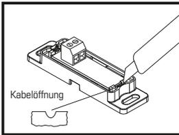
4. Bereiten Sie mit einem Messer die Kabelöffnung am Bodengehäuse für das Steuerkabel vor, indem Sie eine kleine Vertiefung in die Gehäusewand einschneiden.
