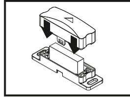
3. Öffnen Sie das Gehäuse bitte nicht. Die Zeichnung veranschaulicht nur die Position des Magneten in seinem Gehäuse.
