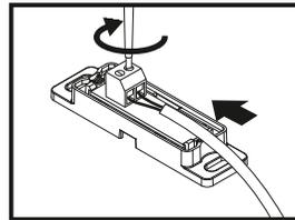
5. Schließen Sie das Steuerkabel an der Klemme an.
