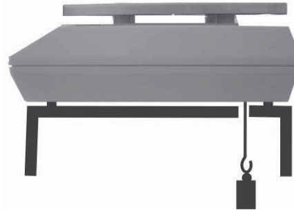
Abb. 1: Einrichten der Waage für Unterflurwägungen
