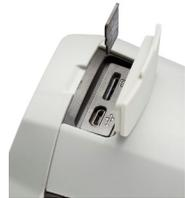
→ **Wird die Speicherkarte bei einer Speicherauslösung über die rote Auslösetaste (9) zur Bildspeicherung nicht erkannt (Kartensymbol mit einem roten X im Display), überprüfen Sie die Speicherkapazität, den korrekten Sitz bzw. die korrekte Datenformatierung (FAT32) der Speicherkarte.**
