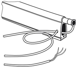
Sender und Empfänger in die Hohlkammer einschieben.
