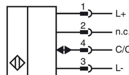
**Elektrischer Anschluss Empfänger**
