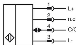
**Elektrischer Anschluss Empfänger**
