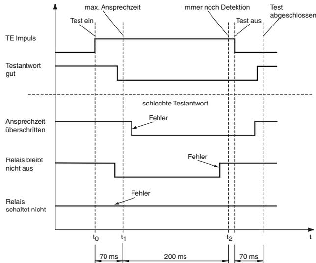
Die Türsteuerung muss den Sensor zu den Zeiten  $t_1$  und  $t_2$  abfragen. Türinnenseite und Türaußenseite müssen wechselweise an- und abgeschaltet werden (Muting) -> bzw. aus der Auswertung von der Türsteuerung genommen werden.
