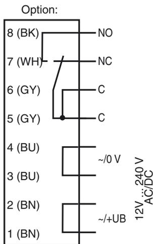
Die Relais-Funktionen "Öffner" und "Schließer" beziehen sich auf die Schaltungsart "Hellschaltung", in deren Stellung sich der Hell-/ Dunkelumschalter auf der Gehäuseoberseite befindet (= Auslieferungszustand).
