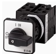
Stufenschalter, T0, 20 A, Zentraleinbau, 5 Baueinheit(en), Kontakte: 10, 30 °, rastend, mit 0-Stellung, 0-10, Abwicklungs Nr. 8248
