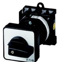
Tastschalter, T0, 20 A, Zwischenbau, 3 Baueinheit(en), Kontakte: 6, 45 °, tastend, mit 0-Stellung, mit 2-seitigem Rückzug, 0-1<START, Abwicklungs Nr. 15064
