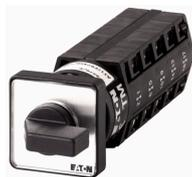
Stufenschalter, TM, 10 A, Einbau, 5 Baueinheit(en), Kontakte: 9, 60 °, rastend, ohne 0-Stellung, 1-3, Abwicklungs Nr. 8270
