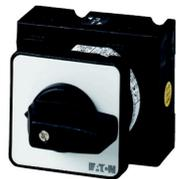
Umschalter, T3, 32 A, Einbau, 2 Baueinheit(en), Kontakte: 4, 90 °, rastend, mit 0-Stellung, 0-1-0-1, Abwicklungs Nr. 8060
