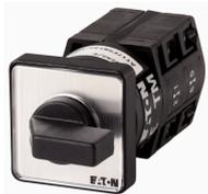
Stufenschalter, TM, 10 A, Einbau, 2 Baueinheit(en), Kontakte: 3, 45 °, rastend, mit 0-Stellung, 0-3, Abwicklungs Nr. 8241
