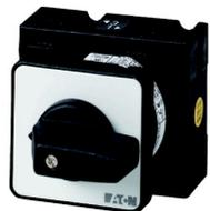
Umschalter, T3, 32 A, Einbau, 2 Baueinheit(en), Kontakte: 4, 45 °, tastend/rastend, mit 0-Stellung, mit Rückzug nach 0, HAND>0-AUTO, Abwicklungs Nr. 15435
