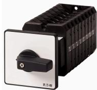
Stufenschalter, T5B, 63 A, Zwischenbau, 8 Baueinheit(en), Kontakte: 16, 45 °, rastend, ohne 0-Stellung, 1-8, Abwicklungs Nr. 15142
